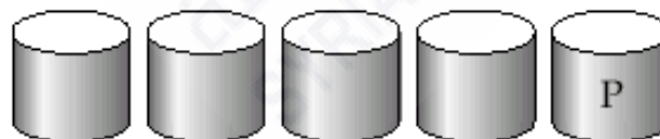
(d) RAID 3: bit-interleaved parity
