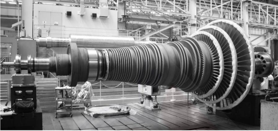
الشكل 10-11: عنفة مكونة من سلسلة عنفات متمحورة وذات أقطار متزايدة تُستخدم لتوليد كهرباء، توضع هذه العنفة داخل أنبوب مخروطي يدخل البخار من فتحته الضيقة ويتمدد أثناء انطلاقه باتجاه الفتحة الواسعة للأنبوب المخروطي دافعاً أجنحة العنفات المتتالية مسبباً دورانها.
