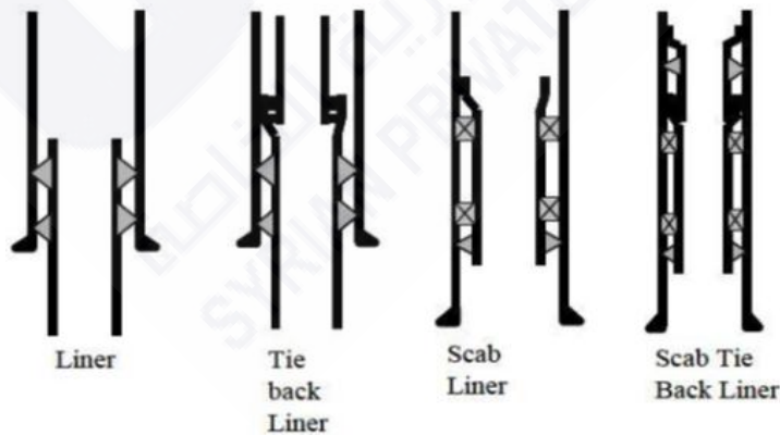
الشكل(3-1) حالات مختلفة لتعليق مواسير التغليف الضائعة
