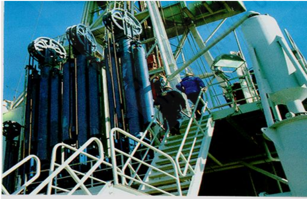
الشكل (5-3) يبين فتحة استقبال الماسورة والماسورة الصاعدة في السفينة .
