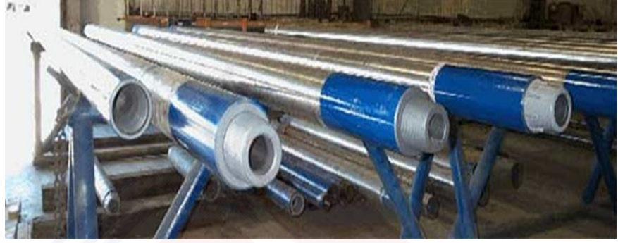
الشكل (24-2) أعمدة حفر غير ممغنطة
