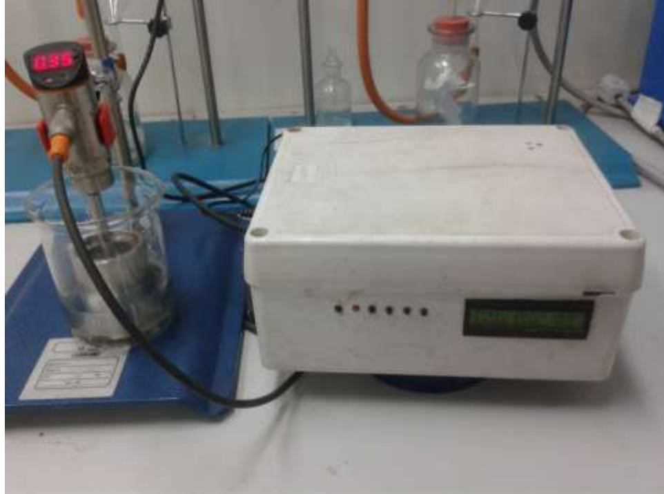
الشكل (2) جهاز قياس ضغط انتفاخ العينة الغضارية بعد تشريبها بالسائل المدروس
